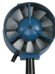
Auf dem Schutzring der beiden Flügelradanemometer (14143) und (14433) gibt ein Pfeil die Richtung an, in der der Wind das Anemometer durchströmen soll.
